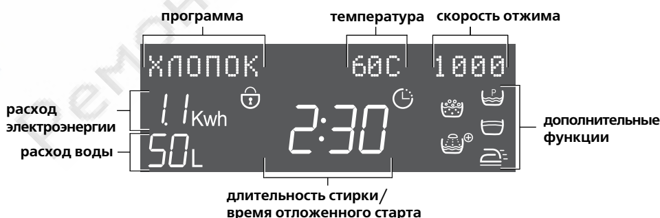
Рисунок 2 — Зоны индикации дисплея
